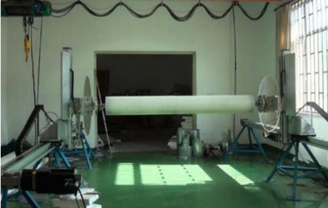
图5-2 双向强迫振荡模型试验装置的（实物图）
