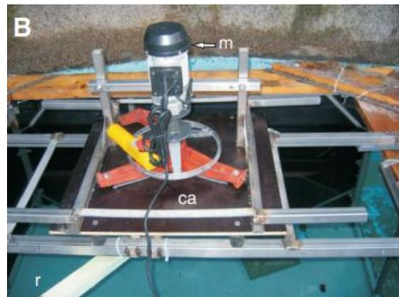
图4-9 实验中柱体试件旋转设备<sup>[23]</sup>
