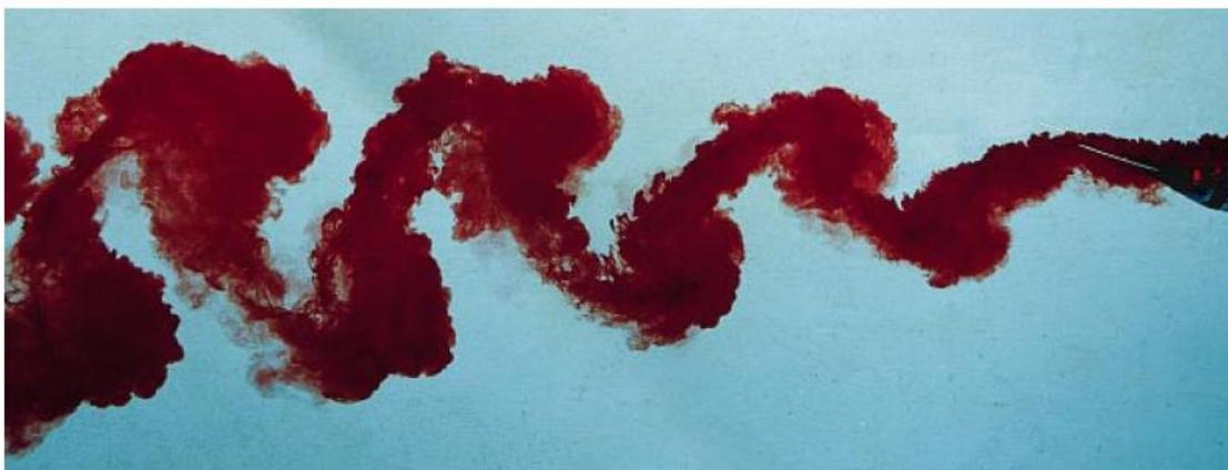
图4-18 RoboTuna 实验照片，可以清楚的看出，在尾流中包含了一系列漩涡<sup>[62]</sup>
